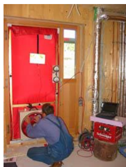
Links: Blowerdoor- Test im EFH
